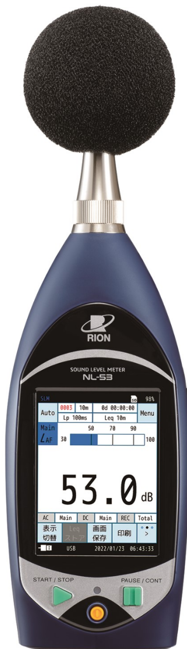
Abbildung 2: Schallpegelmesser NL-53 mit Windschirm Figure 2: Sound level meter NL-53 with windscreen
